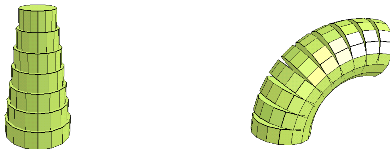
Figura 59: Problemática de las primitivas simples: escalonamiento producido por la variación del grosor (izquierda) y discontinuidades en las curvaturas (derecha).
