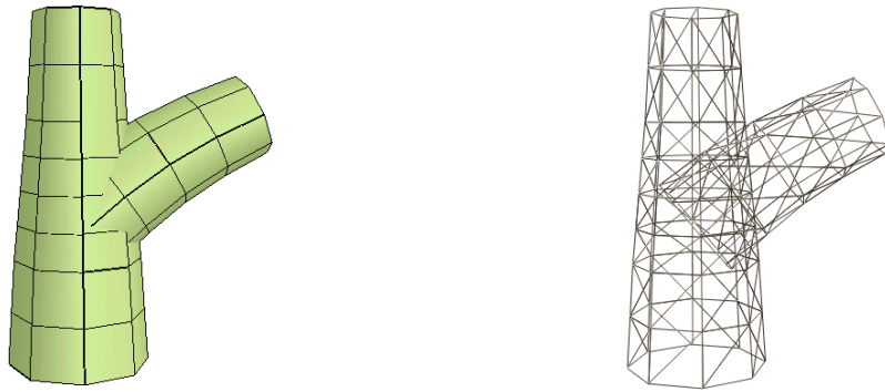
Figura 65: Ramificación de un cilindro generalizado. La base de la rama parte desde uno de los puntos de control del eje principal, pero con la orientación establecida por la dirección de la ramificación.
